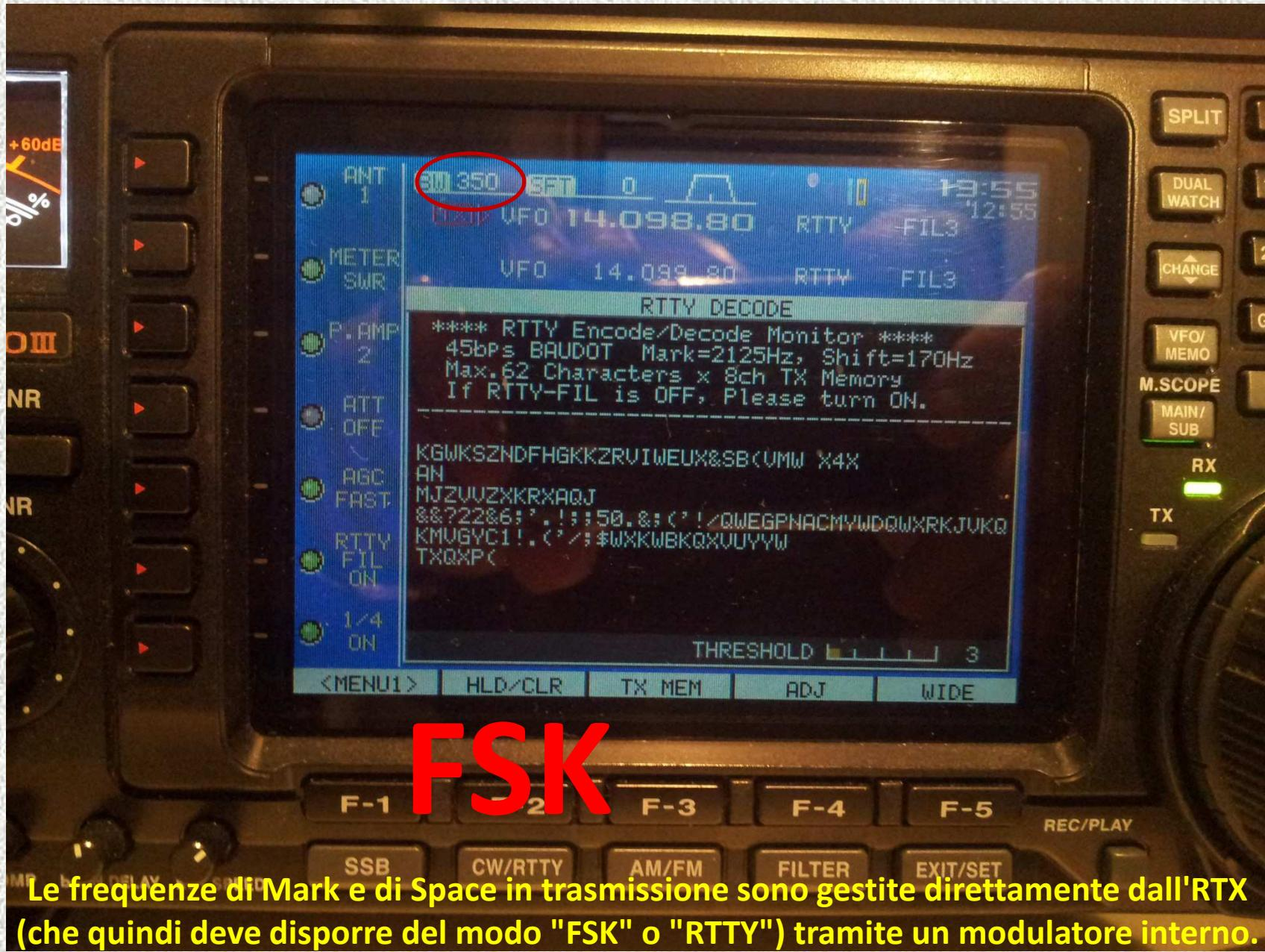
Le frequenze di Mark e di Space in trasmissione sono gestite direttamente dall'RTX
